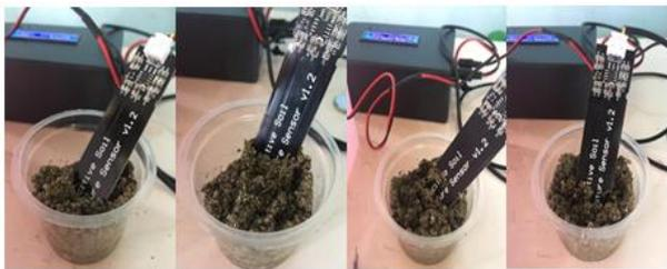
Gambar 9. Probe Sensor ditanamkan pada Tanah II
