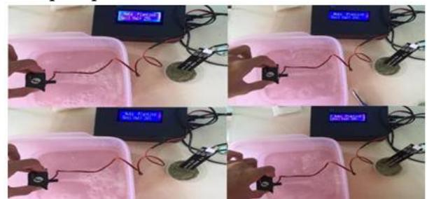
Gambar 11. Pompa Aktif Indikator Tanah Kering
