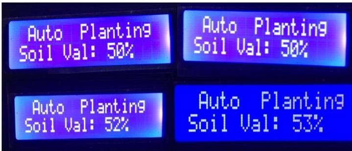
Gambar 5. Tampilan LCD Indikator Tanah Lembab
