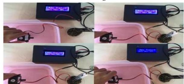
Gambar 12. Pompa Tidak Aktif Indikator Tanah Lembab
