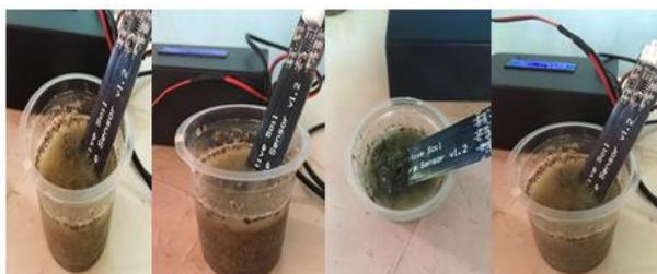
Gambar 10. Probe Sensor ditanamkan pada Tanah III
