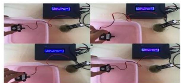
Gambar 13. Pompa Tidak Aktif Indikator Tanah Basah
