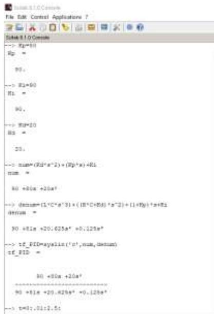
Gambar 15. Perintah penyelesaian sistem tertutup Proporsional Integral Differensial
