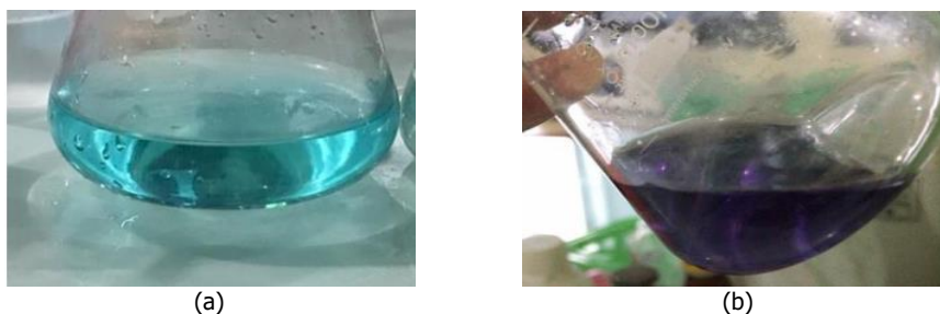
Gambar 1. Penentuan Kadar protein dengan Metode Kjedahl (a) Hasil destilasi, (b) Hasil Titrasi
